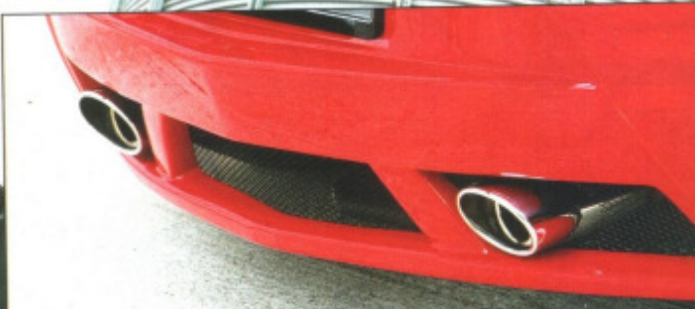
Sauber: Friedrich Motorsport Heckschürzenansatz eingearbeitet - das neue Zuhause der Edelstahl-Auspuffanlage von Fox
